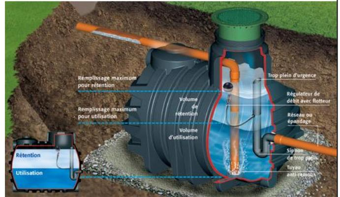
Schéma d'une cuve de rétention (Source GRAF)
